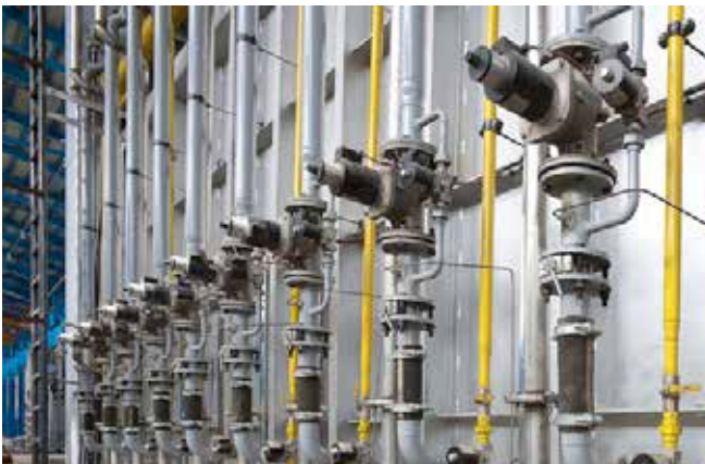
Рис.4: Печь с выдвижным подом с газовыми горелками GBC производства IBS с воздушными клапанами с медленным открытием VML 8 и газовыми клапанами с быстрым открытием VMR 3 Pic. 4: Bogie Hearth furnace with IBS-Gas-burners GBC equipped with slow opening air valves VML 8 and fast opening gas valves VMR 3
