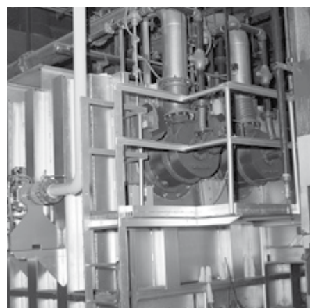
Использование TriOx в печи плавки алюминия
