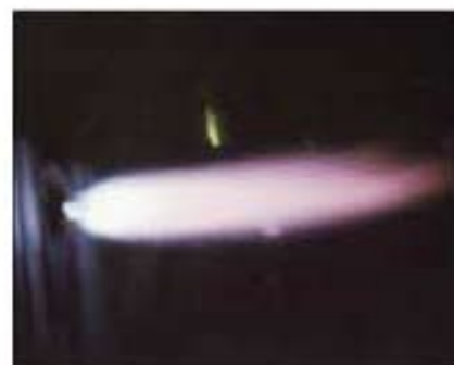
ДЛИННОЕ ПЛАМЯ, СЖИЖЕННЫЙ ГАЗ
